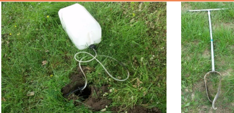
Photographie 2 : Matériel utilisé pour la réalisation des tests d'infiltration de type Porchet
